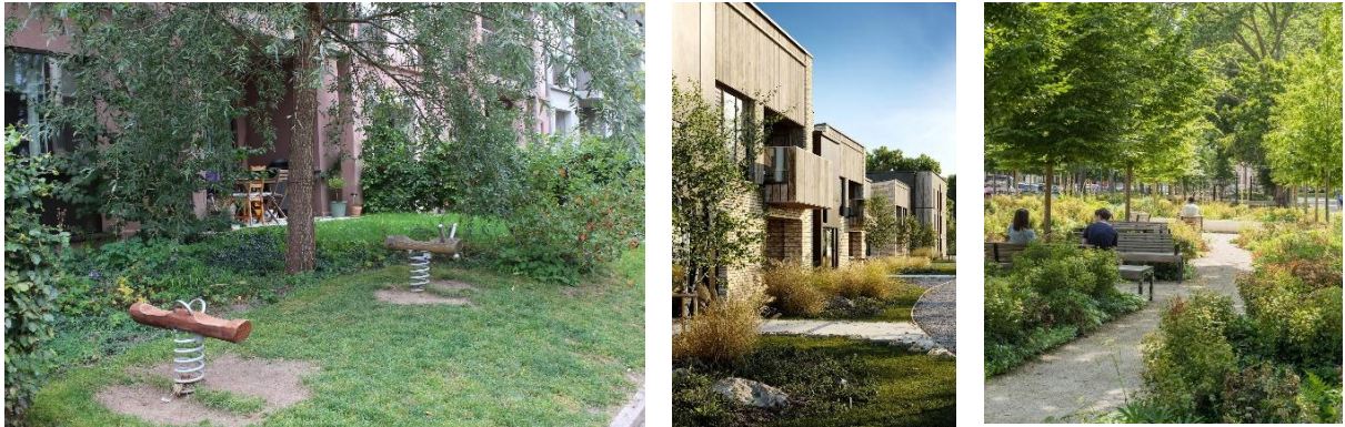
Figur 6-9. Eksempel på løsninger der vegetasjon og nivåforskjeller er benyttet til skjerming av private areal på bakkeplan. Foto: Norconsult/ Pinterest.
