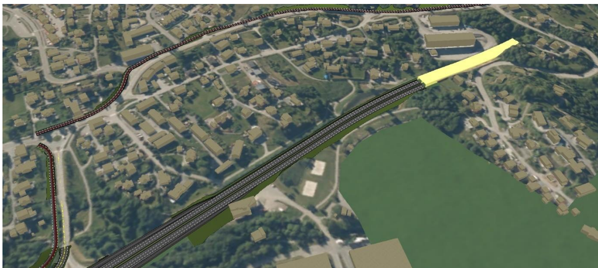
Figur 5-32: Alternativ 2 medfører utvidelse på 15–20 meter inn på friområdet, eksisterende voll fjernes, noe som medfører at grøntarealet mellom sjøen og E39 reduseres. Miljøtunnel til høyre vies med gul farge. Sett mot sørøst
