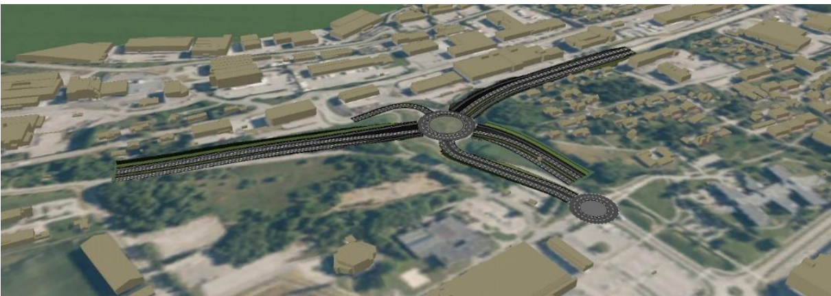
Figur 6-45 Alternativ 2 berører delområdet direkte i øst med arm til 2 etasjers rundkjøring. Sett mot nordøst.
