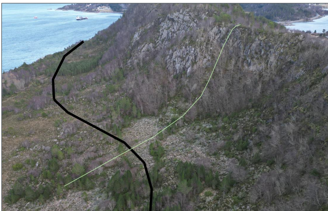
Figur 5 Dronebilde av profil 2 (grønn linje), sett mot øst/sørøst. Svart linje viser omtrentlig planlagt veglinje.
