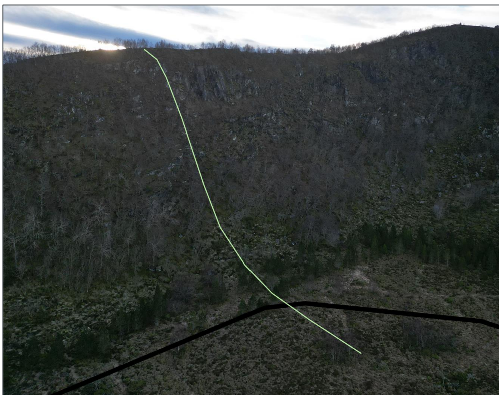
Figur 7 Dronebilde av profil 4 (grønn linje), sett mot sør/sørvest. Svart linje viser omtrentlig planlagt veglinje.
