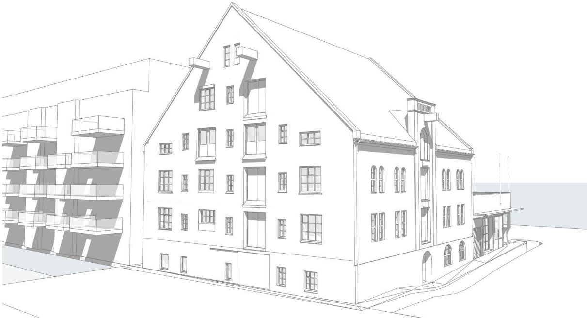
Figur 46. Mulighetsstudie: Eksisterende fasade med en miks av originale vindus-/vindedøråpninger og vinduer av senere tid med annen form og materialbruk enn opprinnelig.
