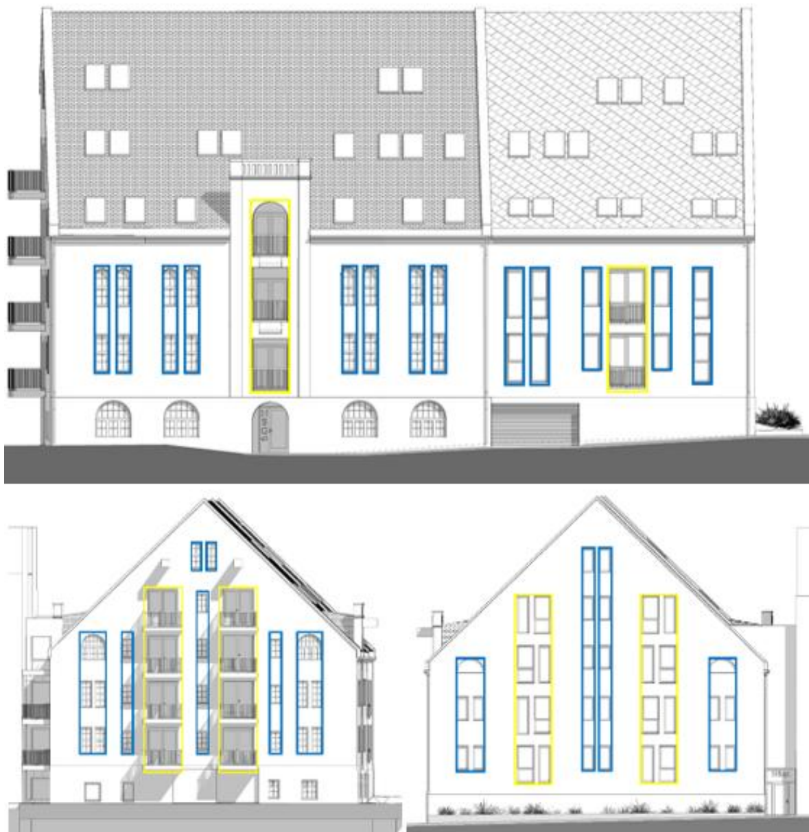
Figur 74. Analyse: Vinduer (blå) og balkongdører/-åpninger (gul) gir et vertikalt uttrykk i fasaden og danner gjenkjennelige geometriske motiv på fasadene og en helhetlig arkitektur.
