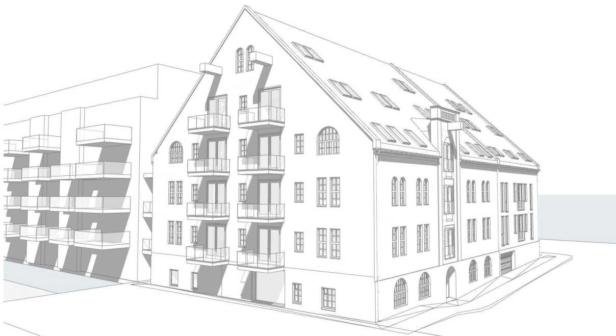
Figur 52. Mulighetsstudie: Opprinnelige vindus-/vindedøråpninger og utenpåhengte balkonger m/glassrekkverk.
