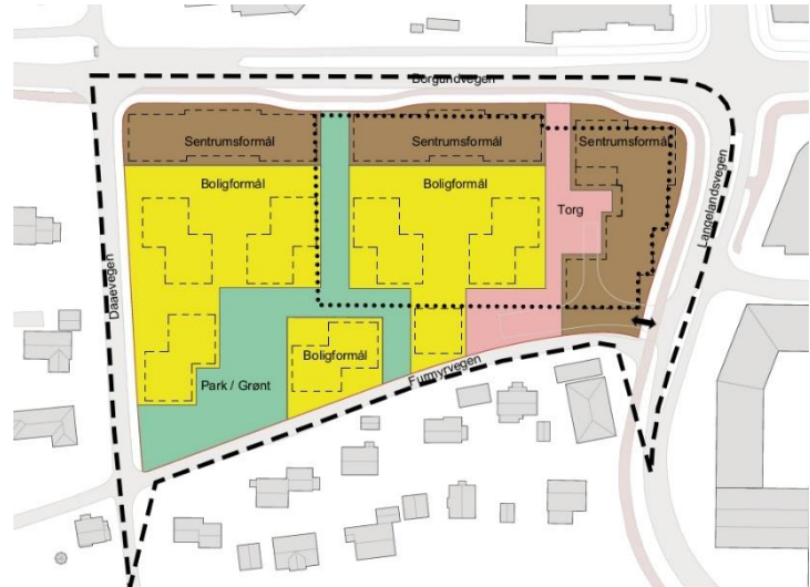
Figur 6 Prinsipp for arealbruk. Pilen markerer inn- og utkjøring til varelevering og parkering under bakken. Omtrentlig utstrekning av parkeringskjeller er vist med prikket linje.
