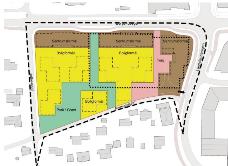
Figur 2-6. Prinsipp for arealbruk. Pilen markerer inn- og utkjøring til varelevering og parkering under bakken. Omtrentlig utstrekning av parkeringskjeller er vist med prikket linje. Illustrasjon: JAJA architects/ Norconsult.
