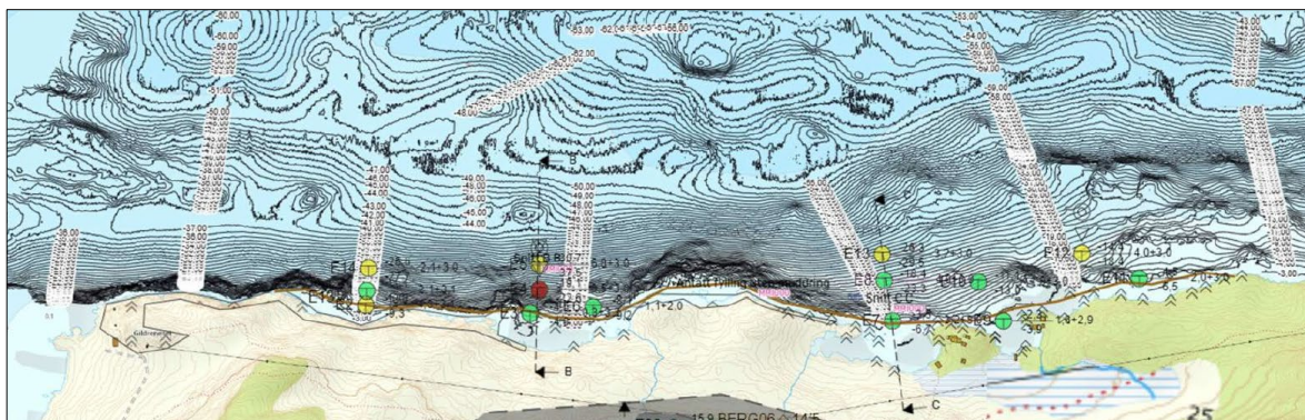
Figur 13: Kart som viser bratt helling av sjøbotnen. På figuren er gule markeringar tolka til å innhalde kvikkleire, raude tolka eintydig å innhalde kvikkleire og grøne friskmelde.
