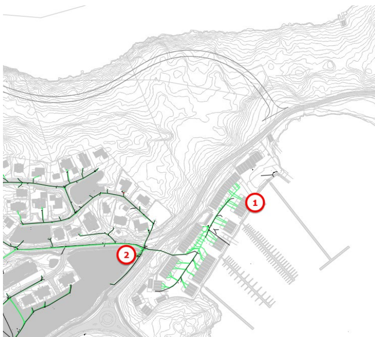
Figur 11 Eksisterende spillvannsnett ved tilkomstvei øst. Pkt. 1 og pkt. 2 viser hhv. privat og kommunal pumpestasjon.
