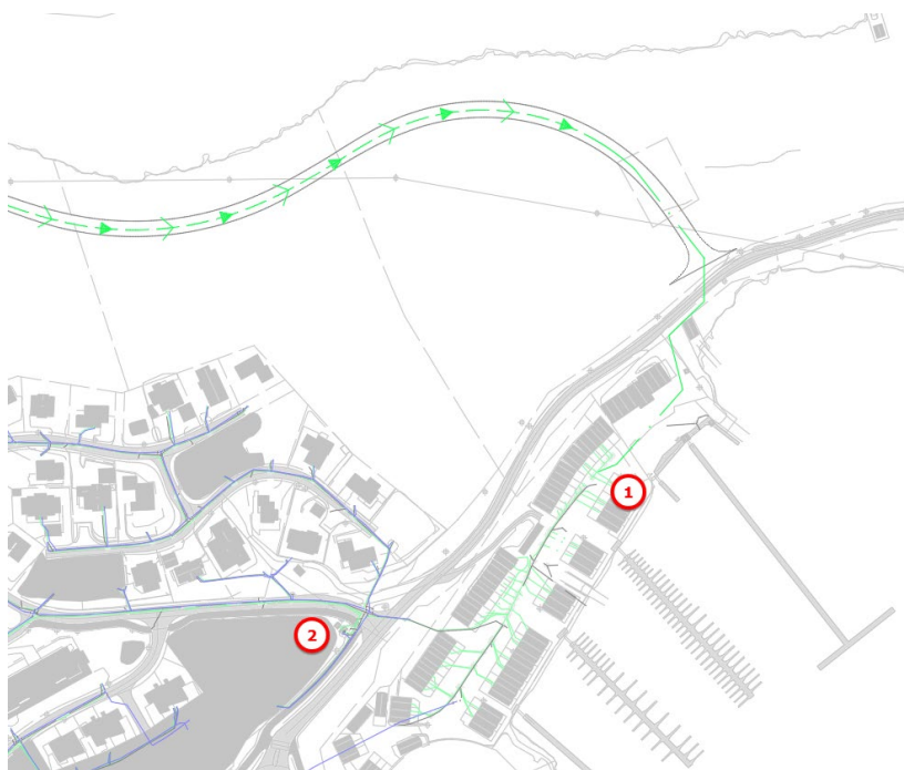
Figur 15 Alternativ med spillvann i øst. Pkt. 1 er en privat pumestasjon som leder vannet til kommunal pumpestasjon, pkt 2.
